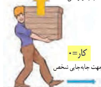
شکل ۴- وقتی نیرو بر جهت جابه جایی عمود باشد، کاری انجام نمی دهد.
