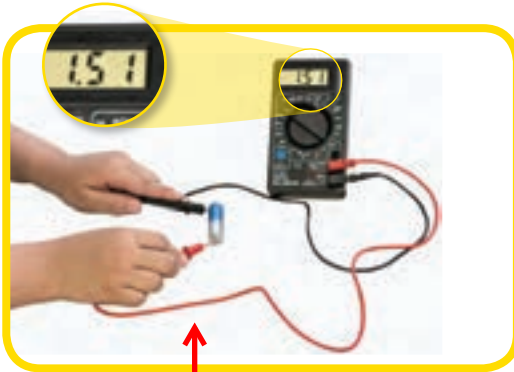
شکل ۶- اندازه‌گیری اختلاف پتانسیل دو سر باتری
