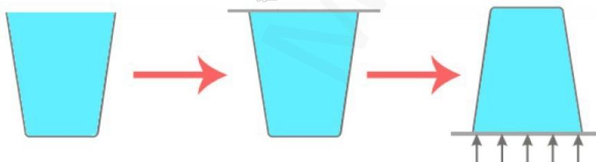
14- در شکل زیر روغن در داخل محفظه محصور است. اگر نیروی  $1000\text{ N}$  به پیستون ورودی اعمال شود، فشار و نیرو در نقاط خروجی را حساب کنید.
