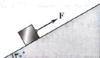
مثال ۴ : مطابق شکل جسم  $M$  با سرعت ثابت به اندازه  $۲۰$  متر در امتداد سطح بدون اصطکاک بالا کشیده می شود. کار نیروی  $F$  چند ژول می باشد؟ (از وزن و اصطکاک صرفه چشم بیوشید)
