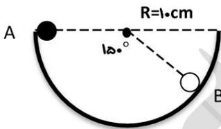
مثال ۴: وزنه ای به جرم  $2 \text{ kg}$ ، از نقطه  $A$  رها شده و با سرعت  $4 \text{ m/s}$  از نقطه  $B$  می گذرد. اگر در هر متر از مسیر، وزنه  $1 \text{ J}$  انرژی از دست بدهد، مسیر  $AB$  چند متر بوده است؟
