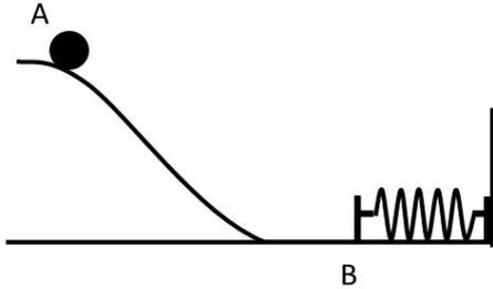
مثال ۹: در شکل رو به رو، نیروی اصطکاک بین جرم و وزنه  $10\text{ N}$  است. این جرم با چه تندی اولیه ای به فنر برخورد کند تا فنر حداکثر به اندازه  $10\text{ cm}$  فشرده شود و انرژی پتانسیل همان جرم-فنر به ژول برسد؟
