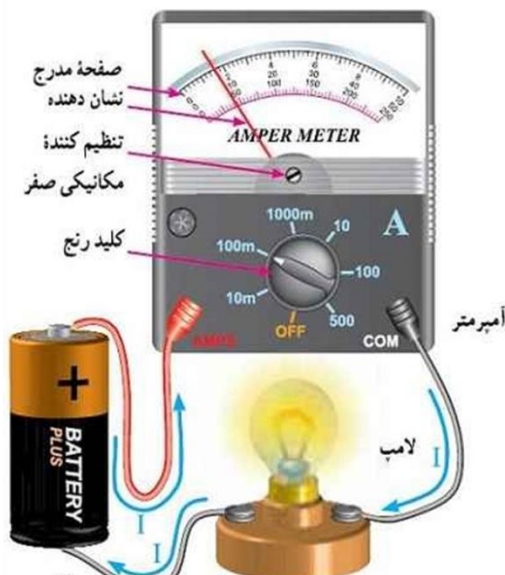
نحوه قرار گرفتن آمپر متر در مدار
