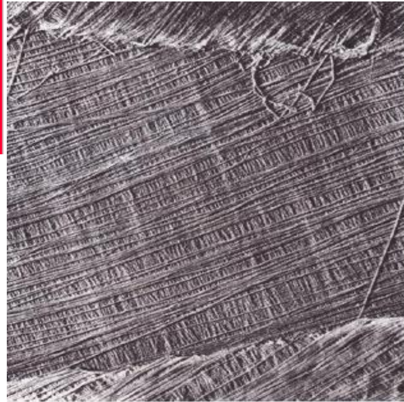
تصویری از ساختار دیواره سلولی زیر میکروسکوپ الکترونی (×۳۰,۰۰۰) جهت گیری رشته های سلولزی را تفسیر کنید.
