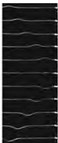
شکل ۳۱-۳۰ چند تصویر لحظه‌ای متوالی از پیشروی و بازتاب یک تپ عرضی در یک فنر بلند کشیده شده که یک سر آن در تکیه‌گاهی واقع در سمت راست، ثابت شده است.
