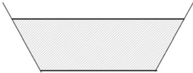
۷۳- در شکل مقابل نشان دهید نیروی وارد بر کف ظرف ناشی از فشار مایع از وزن مایع درون ظرف کم تر است.
