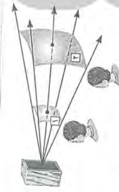
شکل ۱۱-۱۶ با انتشار صوت از چشمه، انرژی به طور عمود، نخست از سطح A و سپس از سطح B که مساحت بيشتري دارد، مي گذرد.
